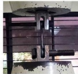
GAMBAR 7. Jig pemegang benda uji.
