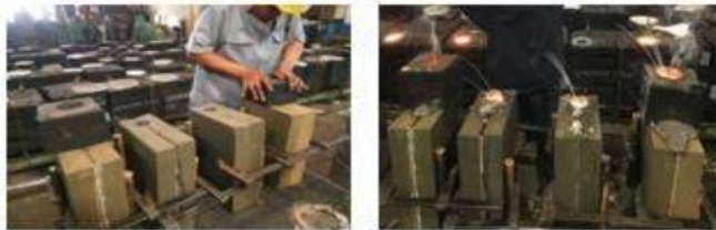
GAMBAR 3. Susunan cetakan saat penuangan.
