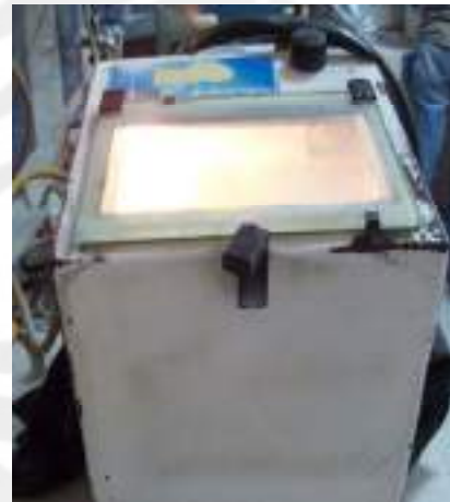
Sandblasting untuk IRK
