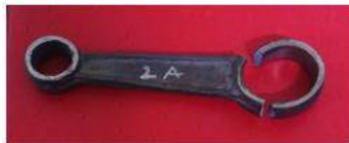
GAMBAR 11. Komponen setelah proses penarikan.
