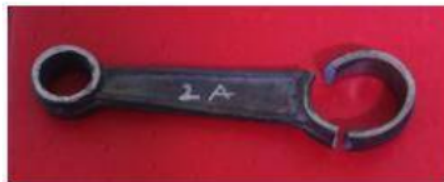
GAMBAR 11. Komponen setelah proses penarikan.
