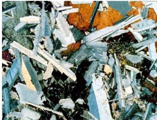
Gambar 2.11 Tektur ofitik pada doleritik (basal); mineral plagioklas dikelilingi oleh mineral olivin dan piroksen klinto
