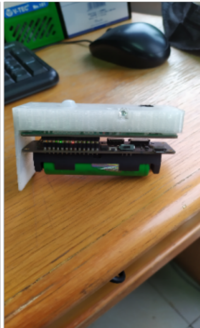
Gambar 3.3 Perangkat pengontrol AC tampak samping
