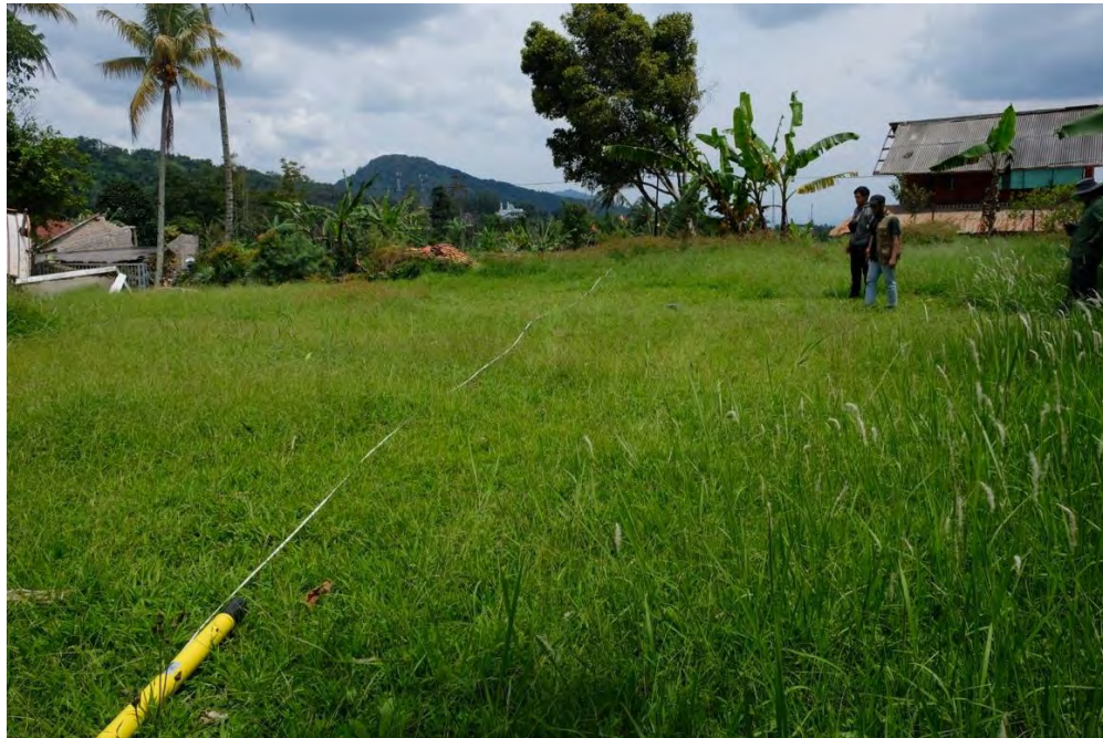
Gambar 5 Proses pengambilan data resistivitas dengan alat ADMT
