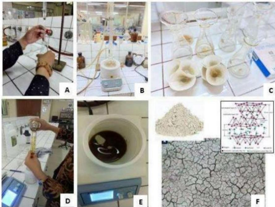
Gambar 2. Persiapan material penjernih minyak jelantah (bentonit aktif) dan validasi proses penjernihan di Laboratorium Kimia FTKE-USAKTI
