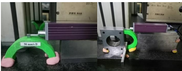
Gambar 4. Pengukuran Kekasaran Permukaan
