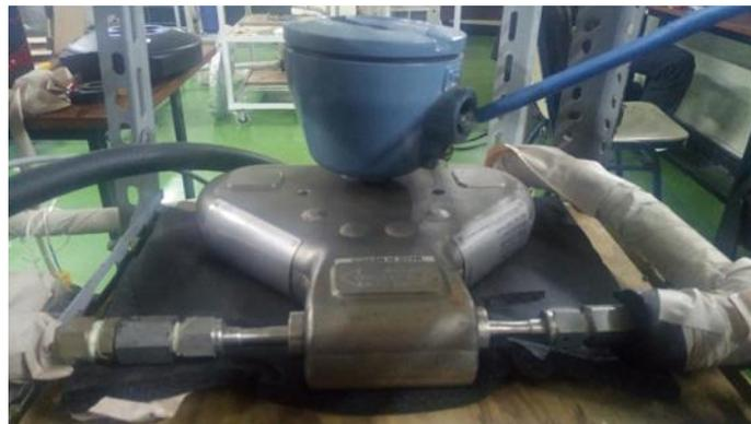
Gambar 3.10. Coriolis Flow Meter
