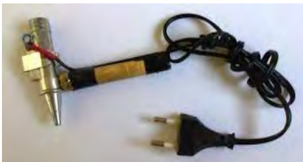
Gambar 31. Model canting elektronik dengan pemanas PTC (Sudirtha dan Nurhayata, 2016)
