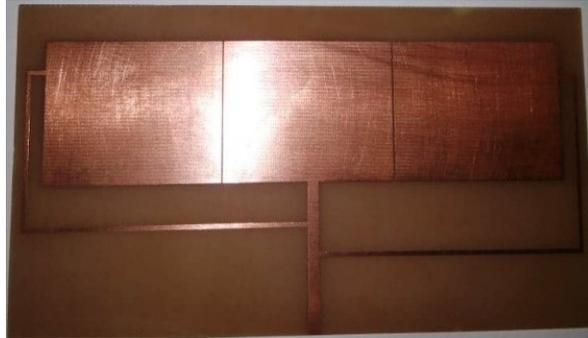
**Gambar 3.23** Hasil Pabrikasi Antena Mikrostrip Tahap Awal Tampak Depan
