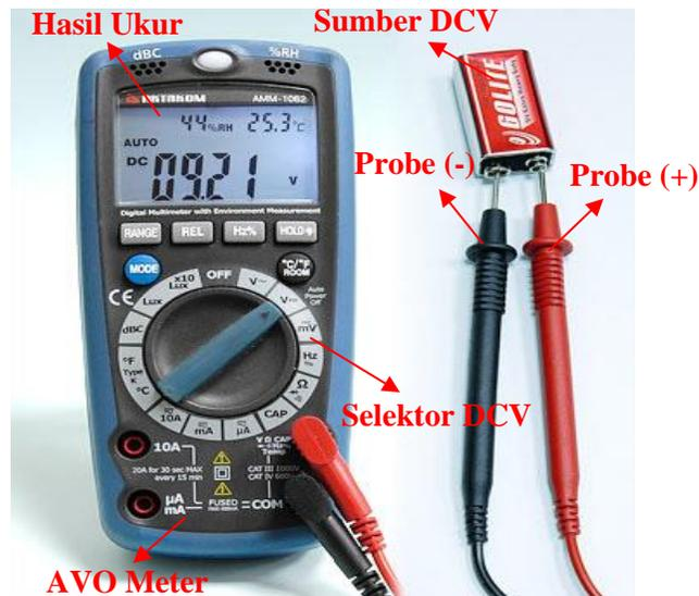
**Gambar 4.4** Proses Pengukuran Tegangan DC
