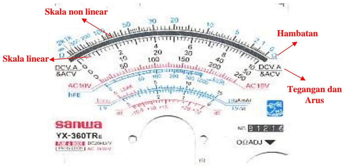
Gambar 4.7 Skala ukur pada AVO Meter analog.
