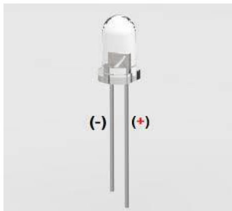
Gambar 2.1 LED dan Kaki Katoda dan Anoda
