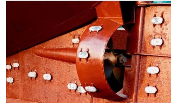
Gambar 3.2 Anoda korban pada kapal (Indonesia Marine Equipment, 2019)
