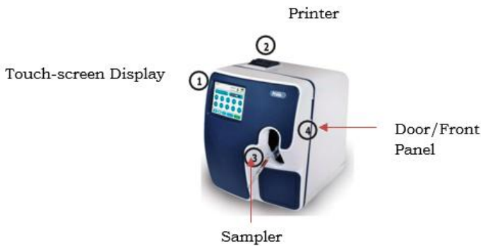
Gambar 4.7 Instrumen Blood Gas Analyzer dan komponennya (Sumber: Pradika, dkk., 2023).
