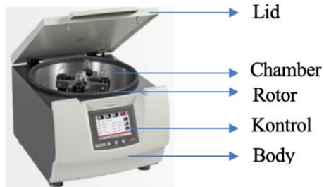
Gambar 4.2 Komponen pada sentrifugasi (Sumber: PT. Andaru Analitika Sains, (2021).
