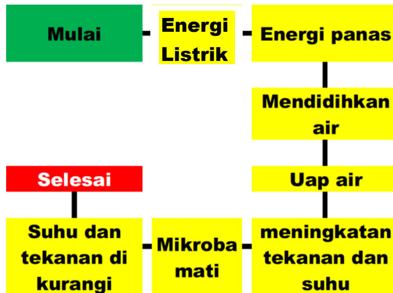
Gambar 1. Cara Kerja Autoklaf
