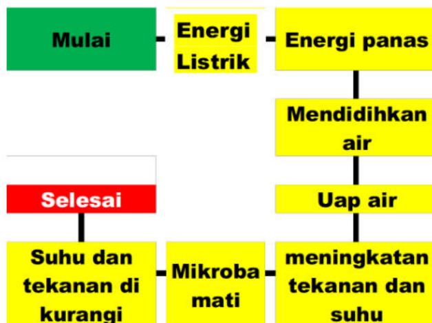
Gambar 1. Cara Kerja Autoklaf
