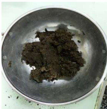
Gambar 3. Adonan briket setelah dicampur perekat
