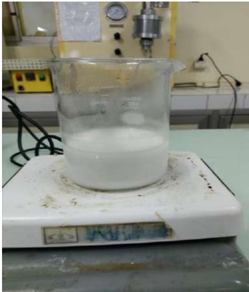
Gambar 4. Larutan perekat ketika dilarutkan dalam air
