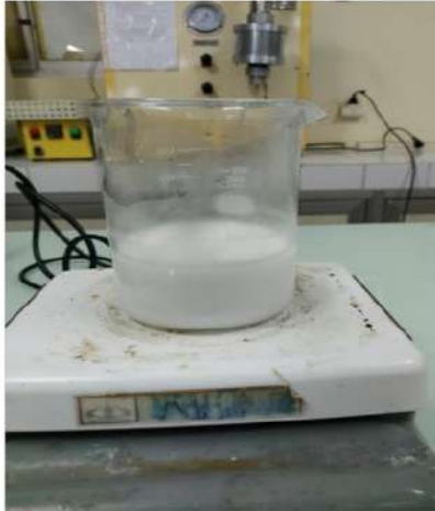
Gambar 4. Larutan perekat ketika dilarutkan dalam air
