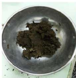
Gambar 3. Adonan briket setelah dicampur perekat
