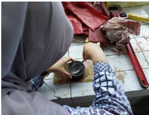
Gambar 5. Proses pencetakan briket dan cetakan
