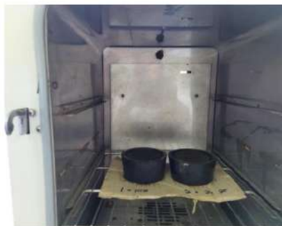
Gambar 6. Proses pengeringan briket
