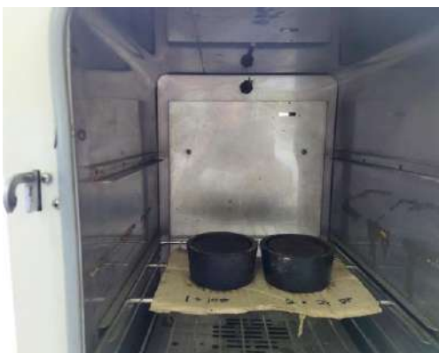
Gambar 6. Proses pengeringan briket
