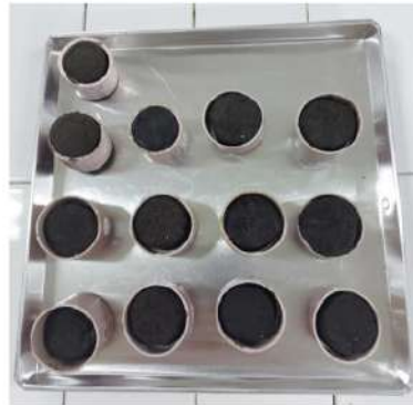
Gambar 7. Briket yang sudah dikeringkan
