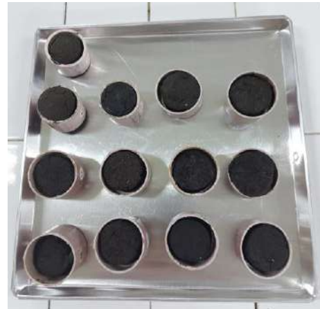
Gambar 7. Briket yang sudah dikeringkan
