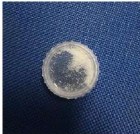
Gambar 1b. Bio-Oss Collagen Setelah Perendaman dengan larutan SBF
