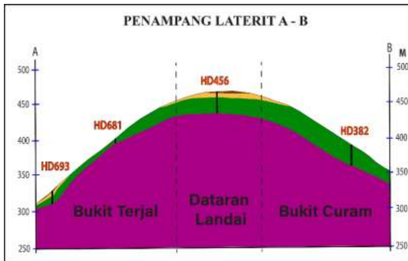
Gambar 2. Penampang Laterit A-A' Sumber: Analisis Penulis (2024)
