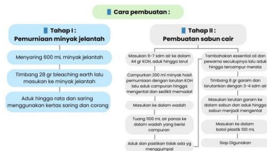
Gambar 7: Skema cara pembuatan 2 tahap pengolahan minyak jelantah Selanjutnya, sebagai inisiasi
