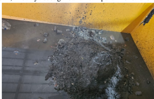
Gambar 5. Bottom ash pada pengolahan sampah secara termal
