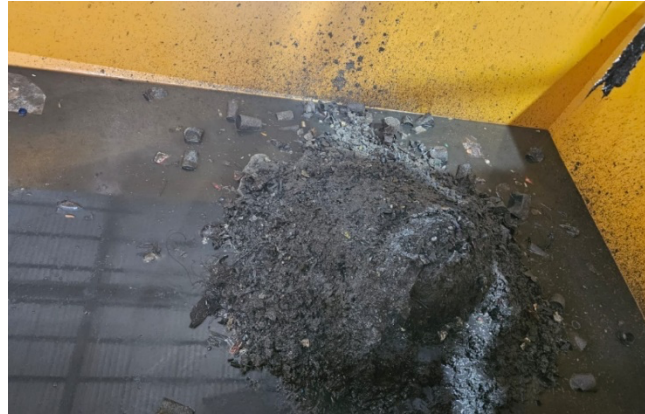
Gambar 5. Bottom ash pada pengolahan sampah secara termal
