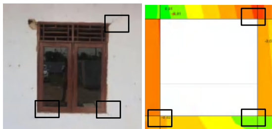
Gambar 10. Perbandingan di tampak elevasi 3 (jendela kanan)
