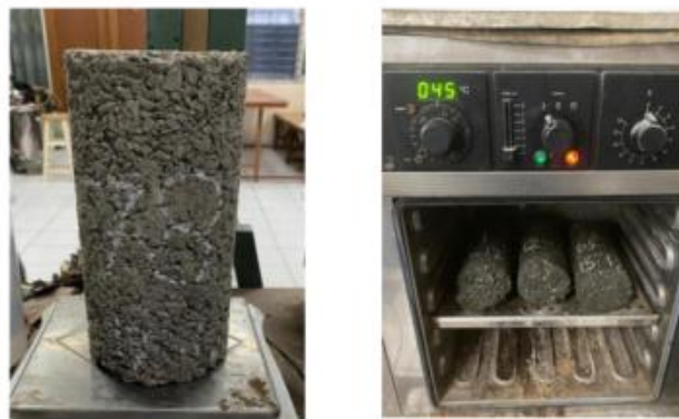
Gambar 5. Benda Uji Beton Berpori Untuk Pengujian Porositas BPS
