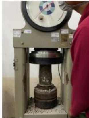
Gambar 2. Pengujian Kuat Tekan Benda Uji Silinder Beton Berpori
