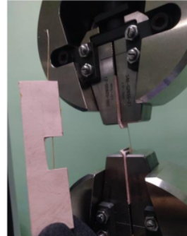
Gambar 4. Uji Tarik Serabut Kelapa
