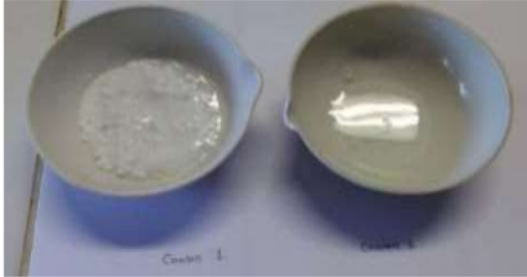
Gambar 49. Cawan porselen untuk membuat krim ekstrak daun L. camara Linn. Cawan 1 mengandung asam stearat, cetylalcohol dan parafin cair. Cawan 2 mengandung metil paraben TEA dan gliserol. Fotografer: Hosea Jaya Edy (2022).
