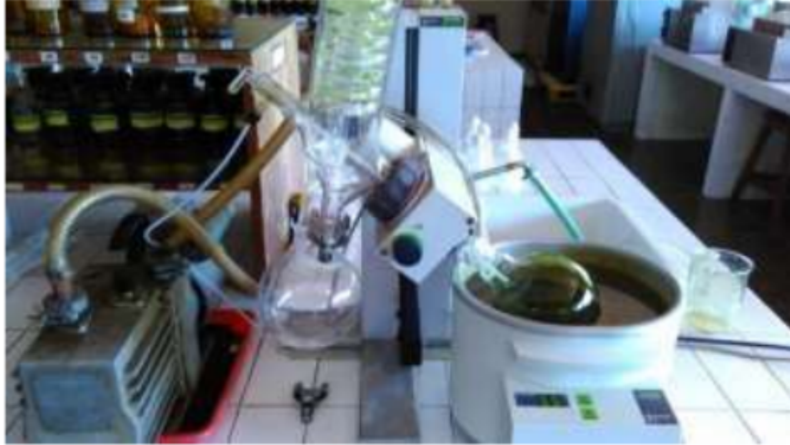
Gambar 29. Pemekatan awal ekstrak cair daun L. camara Linn. menggunakan rotary evaporator. Fotografer: Hosea Jaya Edy, 2022.
