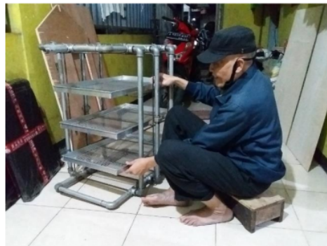
Gambar 6: Rangkaian pipa galvanis yang telah siap dirancang bangun lengkap dengan rak pengering daun teh.
