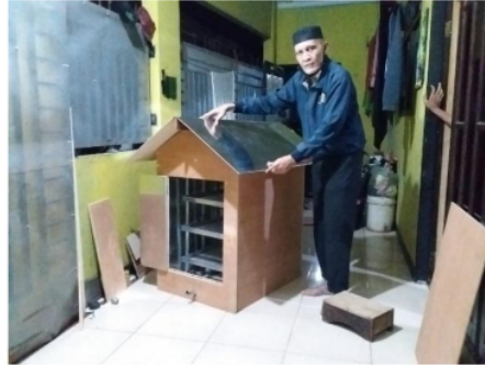
Gambar 7: Rangkaian pipa galvanis lengkap dimasukkan dalam kotak tertutup yang berfungsi sebagai oven pengering.
