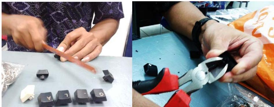
**Gambar 5.** Proses pelepasan dasar tombol *keyboard* komputer dengan cara dipotong menggunakan tang (kiri) dan dengan gergaji besi (kanan)
