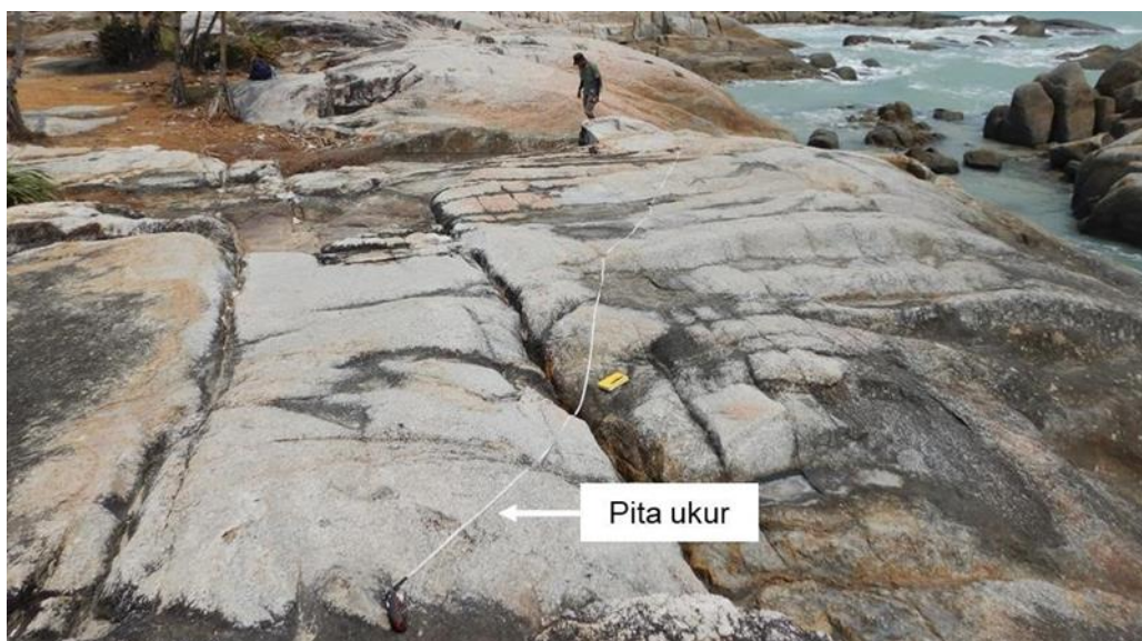
Gambar 3 Metode linear scanline dengan menggunakan pita ukur dan kompas geologi dilakukan dalam pengambilan data rekahan.
