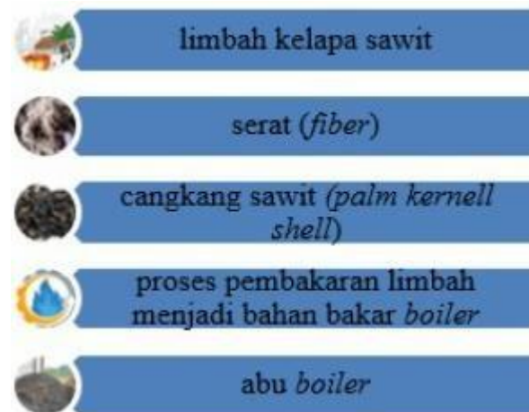
Gambar 3. Proses terbentuknya abu boiler sawit
