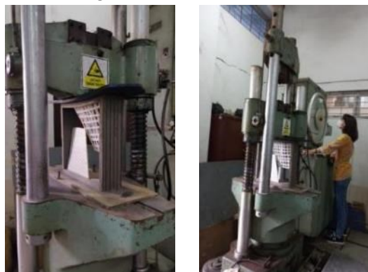
Pengujian beban pada prototype unit roster
