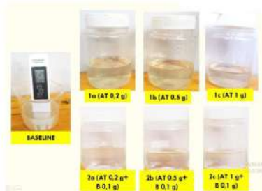
Gambar 5. Hasil percobaan variasi massa menggunakan ampas tebu, kombinasi bentonite dan ampas tebu
