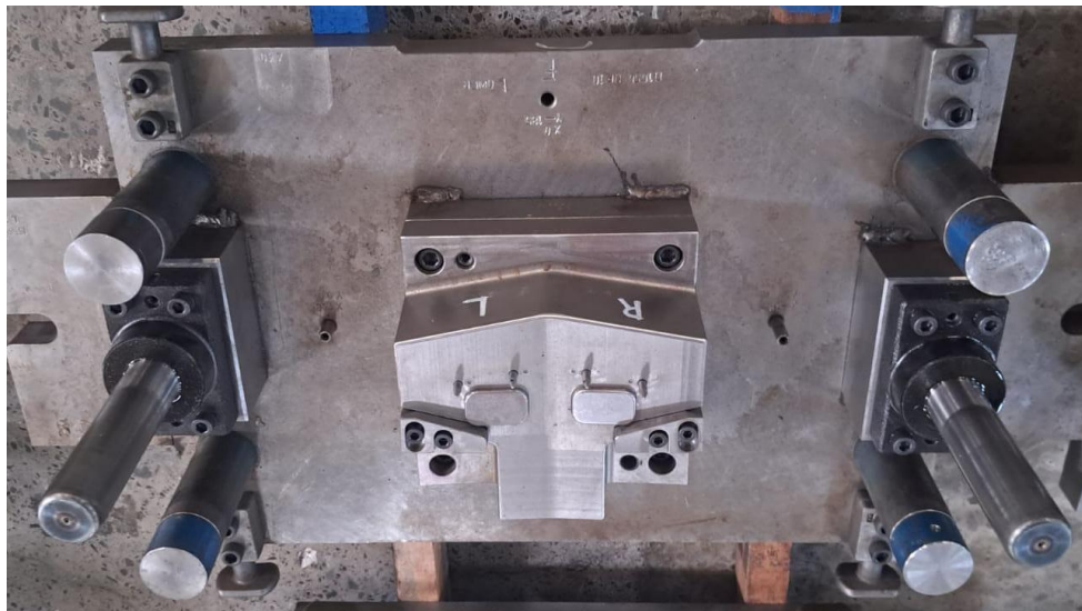
Gambar 4. 25 Dies OP 10 Setelah Perbaikan
