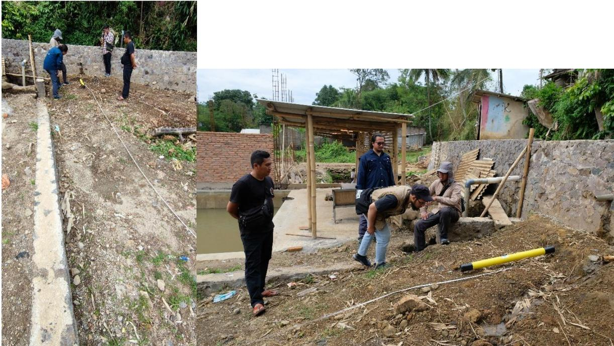
Gambar 2.2 Gambar 4 Proses pengambilan data resistivitas dengan alat ADMT di sekitar Desa Nagrak
