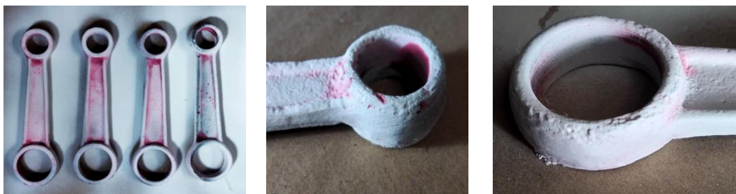
Gambar 7. Hasil Pengujian Dye Penetrant Paska Uji Lelah
