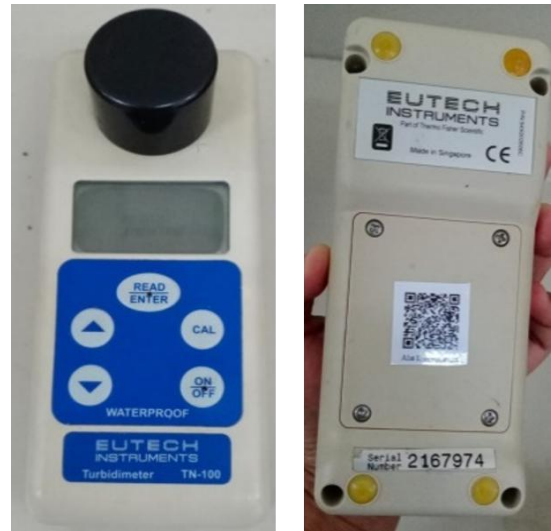
Gambar 7. Alat Turbidimeter Mengukur Kekeruhan Air
