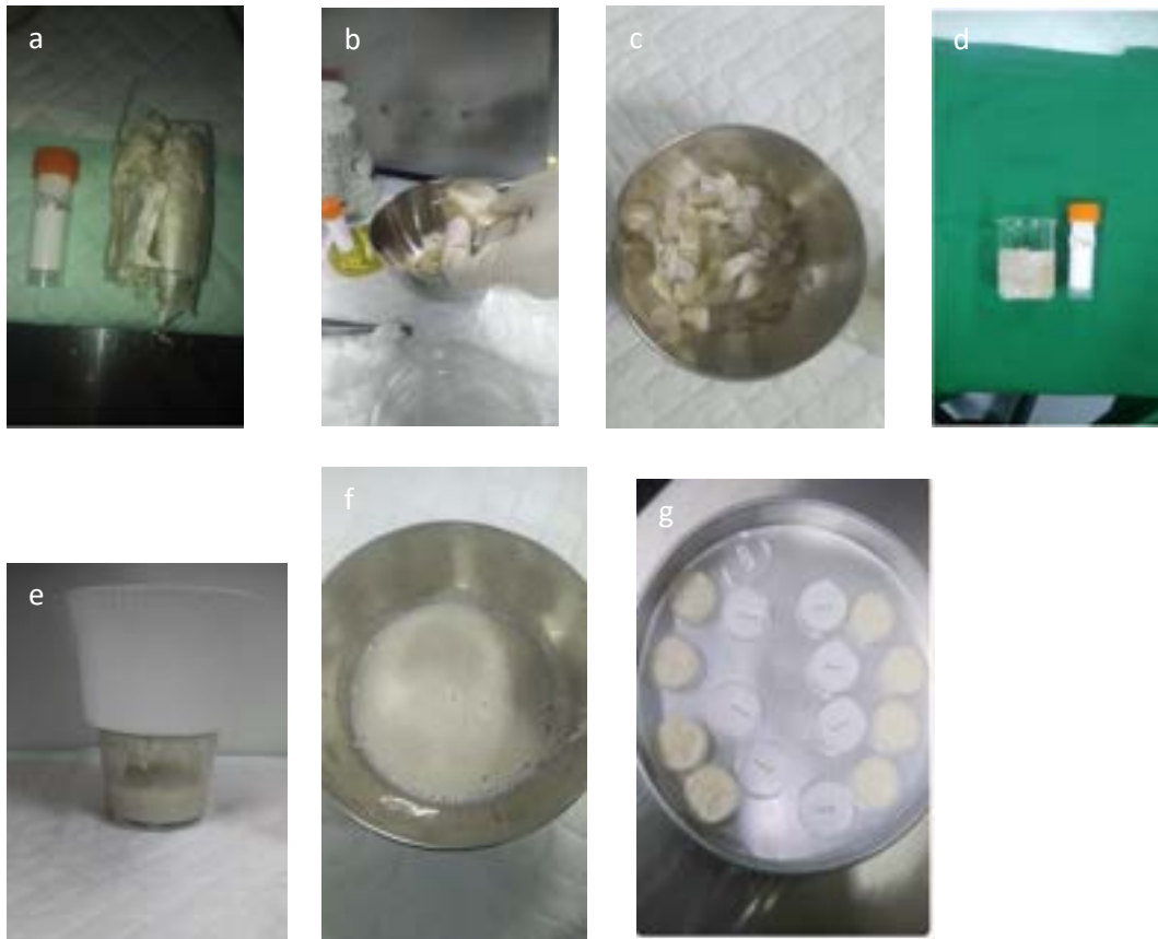
Gambar 1 Proses Pembuatan BAM-HA (a) Persiapan BAM-HA, (b) Proses pemotongan BAM, (c) Hasil pemotongan BAM, (d) Perendaman BAM dengan NaCl 0,9%, (e) proses penghalusan dengan blender, (f) BAM-HA yang sudah homogen (g) biokomposit BAM-HA yang siap di freeze dan freeze drying .
