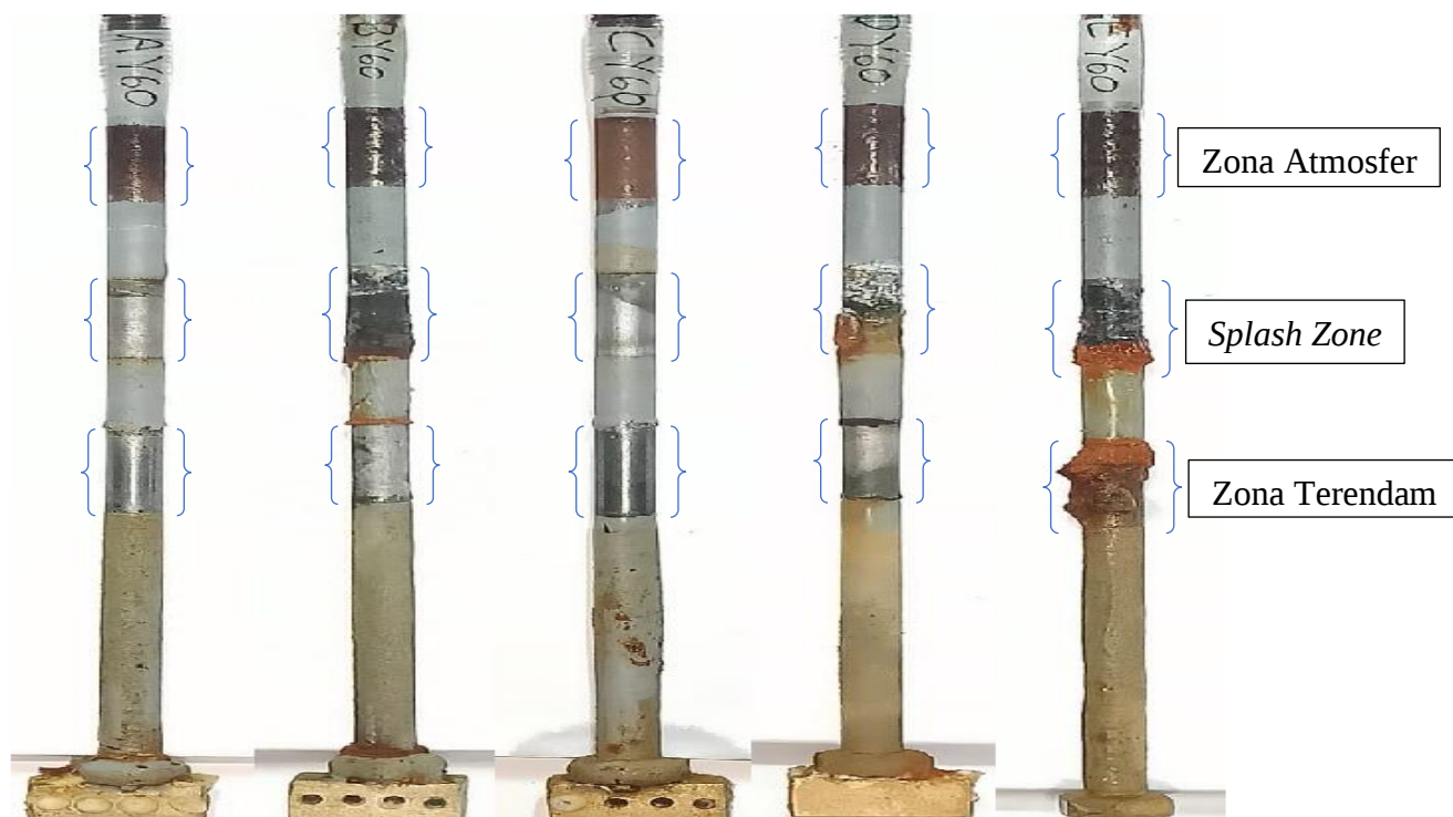
Gambar 4.12 Sampel 2 (Y) Sesudah Pengujian 60 Hari (1440 Jam)
