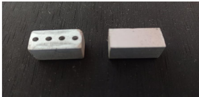
Gambar 2.4 Anoda Korban Aluminium Berpori dan Solid
