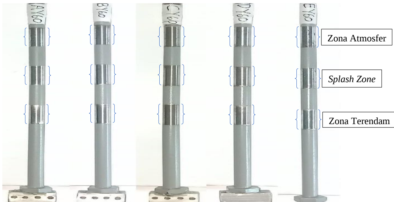
Gambar 4.10 Sampel 2 (Y) Sebelum Pengujian 60 Hari (1440 Jam)
