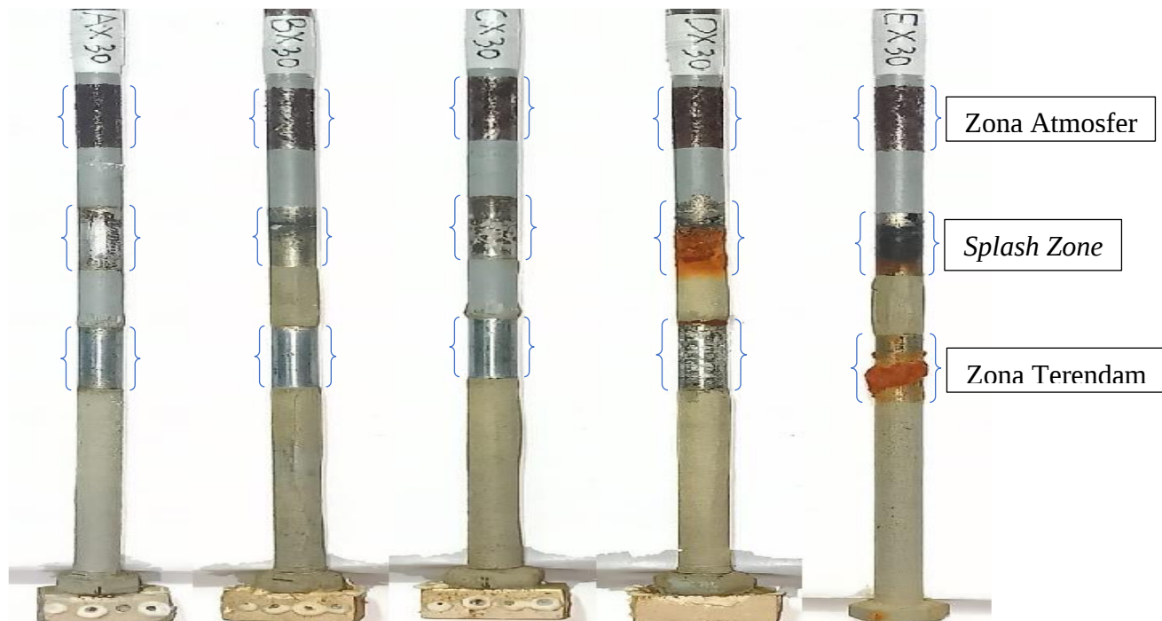
Gambar 4.7 Sampel 1 (X) Sesudah Pengujian 30 Hari (720 Jam)
