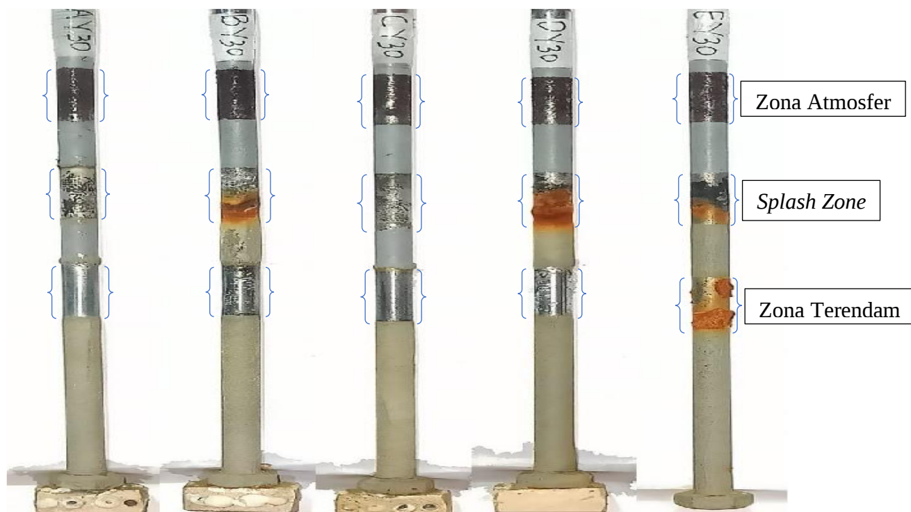
Gambar 4.8 Sampel 2 (Y) Sesudah Pengujian 30 Hari (720 Jam)
