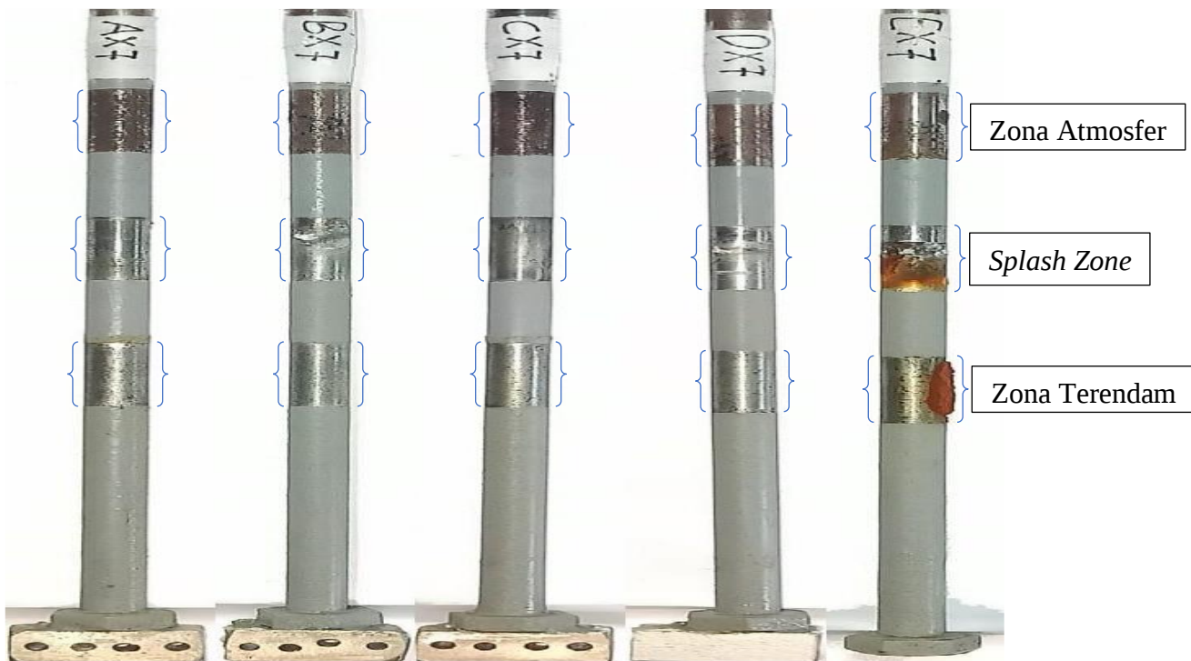
Gambar 4.3 Sampel 1 (X) Sesudah Pengujian 7 Hari (168 Jam)
