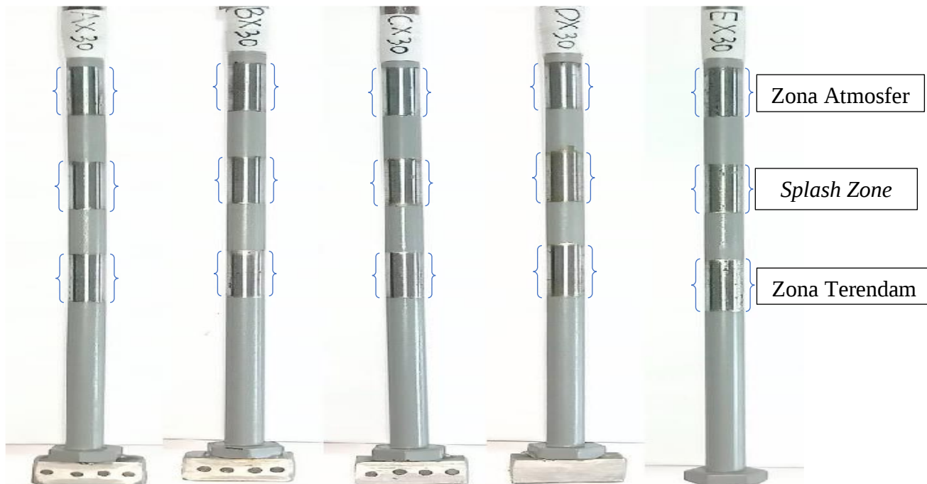
Gambar 4.5 Sampel 1 (X) Sebelum Pengujian 30 Hari (720 Jam)
