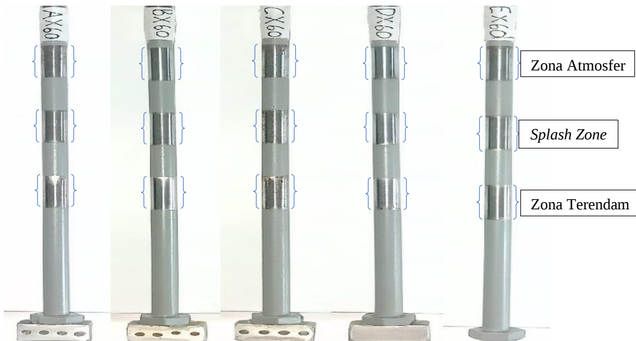
Gambar 4.9 Sampel 1 (X) Sebelum Pengujian 60 Hari (1440 Jam)
