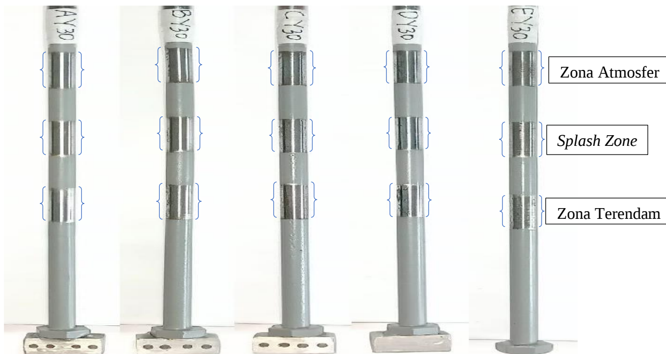
Gambar 4.6 Sampel 2 (Y) Sebelum Pengujian 30 Hari (720 Jam)
