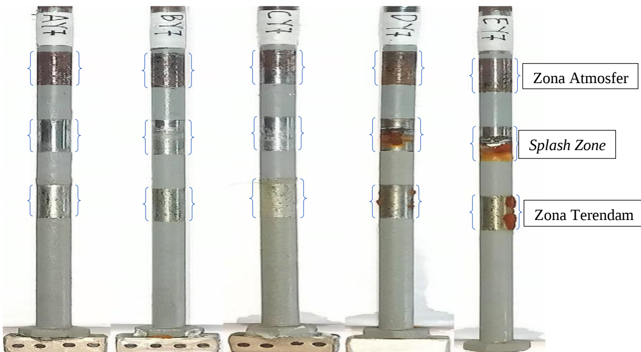
Gambar 4.4 Sampel 2 (Y) Sebelum Pengujian 7 Hari (168 Jam)
