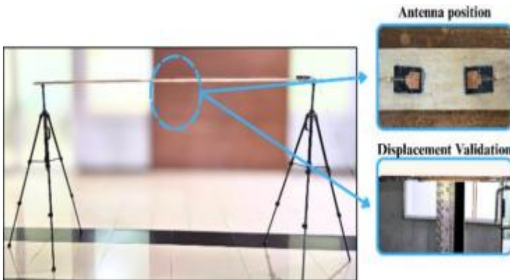
Gambar 9.8 Ilustrasi skema eksperimen laboratorium untuk pengujian kemampuan sensor dalam mendeteksi lendutan pada struktur.
