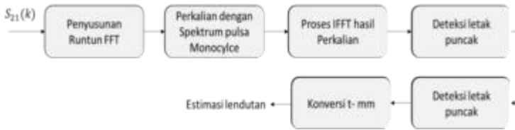
Gambar 9.9. Tahapan pengolahan data S_{21} pada proses deteksi lendutan struktur dengan antenna uwb tekstile sebagai sensornya.
