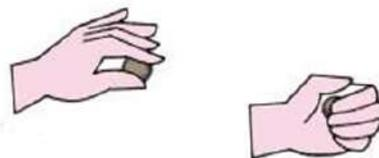
**Gambar 6.2:** Prosedur Pengujian Konsistensi Tanah Lembab
