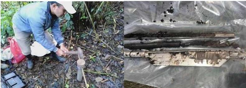
**Gambar 12.2:** Di sebelah kiri: pengambilan contoh tanah dengan core drilling. Di sebelah kanan: hasil pengambilan sampel core pada berbagai kedalaman (koleksi pribadi).
