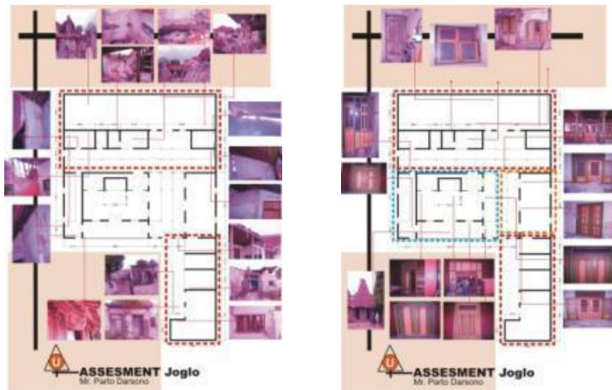
Gambar 10.11. Pengukuran dan penggambaran detail untuk rumah tradisional joglo “Omah UGM”. Pada gambar, ditandai bagian-bagian yang mengalami kerusakan.
