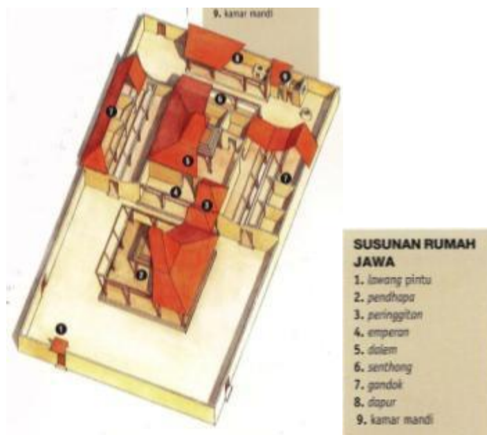
Gambar 10.2. Susunan ruang rumah tradisional Jawa di Kotagede. Sebuah rumah yang lengkap biasanya terdiri dari sembilan komponen, yaitu pintu depan, pendapa, peringgitan, emperan, dalem, senthong , gandok, dapur dan kamar mandi
