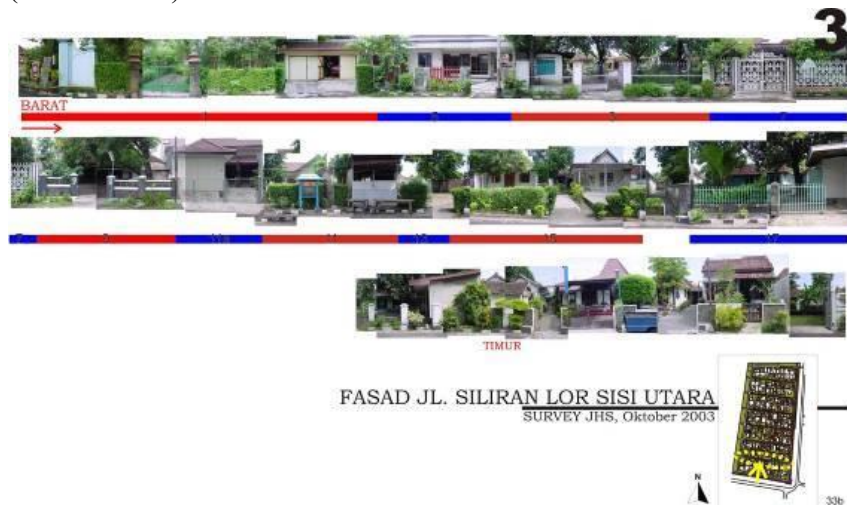
Gambar 4.15. Bangunan-bangunan di penggal jalan yang khas disajikan dalam bentuk serial fasad. Dengan gambar ini, dapat dikenali ciri-ciri yang dominan dan menciptakan harmoni, seperti ketinggian, lebar dan elemen-elemen arsitektural pada bangunan (Sumber: JHS 2006).
