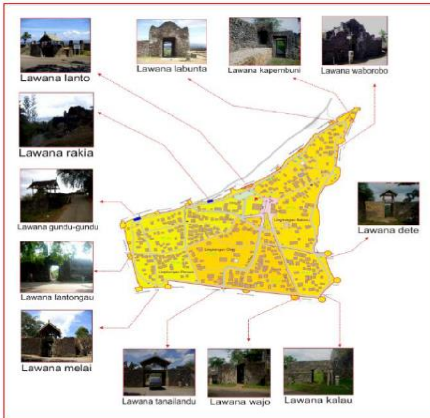
Gambar 4.14. Benteng Wolio dibangun sejak masa pemerintahan Sultan Buton yang ke tiga (1591-1598) hingga rampung nanti pada pemerintahan Sultan keenam (1634-1645). Pembangunan dimulai dengan mendirikan bastion disetiap sudut kota. Benteng ini memiliki keliling sebesar 2.740 meter, dengan tinggi antara 2 hingga 8 meter, ketebalan dinding 1,5 hingga 2 meter, serta dilengkapi dengan 12 pintu gerbang (Sumber: RAKP Kota Baubau 2012).
