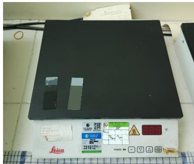
Gambar 6. Pengeringan jaringan menggunakan hotplate
