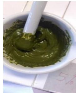
Gambar 52. Peleburan ekstrak daun L. camara Linn. dalam basis krim. A. Basis krim mengandung ekstrak daun L. camara Linn. 3%. B. Basis krim mengandung ekstrak daun L. camara Linn. 4%. C. Basis krim mengandung ekstrak daun L. camara Linn. 5%. Fotografer: Hosea Jaya Edy (2022).
