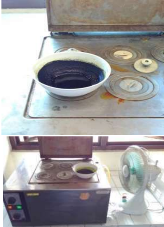
Gambar 31. Pemekatan ekstrak daun L. camara Linn. dengan bantuan waterbath dan kipas angin. A. Pemekatan ekstrak daun L. camara Linn. dalam cawan porselen pada waterbath. B. Pemekatan ekstrak daun L. camara Linn. dalam cawan porselen pada waterbath dibantu dengan kipas angin. Fotografer: Hosea Jaya Edy, 2022.
