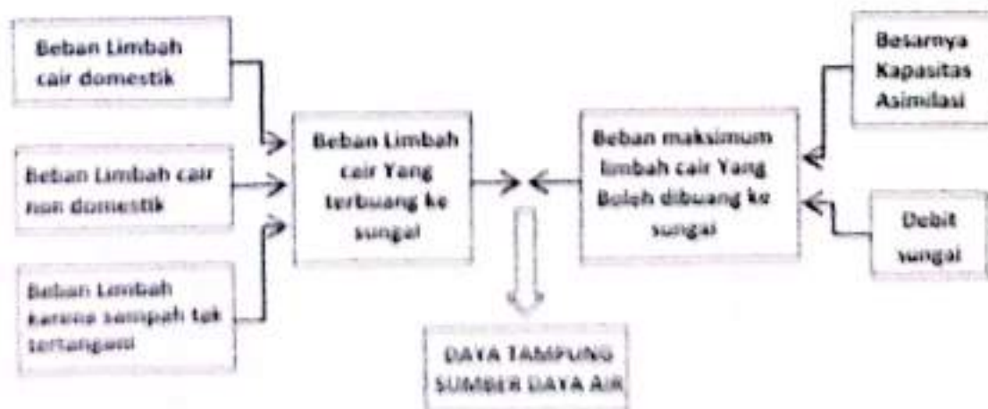
Gambar 3.3. Skema Daya Tampung Sumberdaya Air
