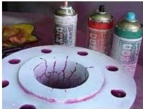
Gambar 3.4 Aerosol Dye Penetrant (Tabung, Cleaner, Tabung Penetrant, Tabung Developer) Dan Contoh Hasil Pengujiannya
