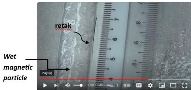
Gambar 5.6. Hasil penyemprotan wet magnetic particle keatas permukaan lasan. Terlihat adanya garis retak dengan panjang sekitar 2 cm. (Anmol birring, 2013)
