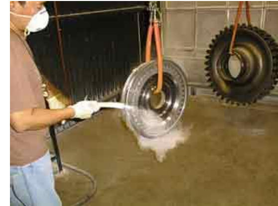
Gambar 3.7 Aplikasi Developer kering (IOWA,2024)
