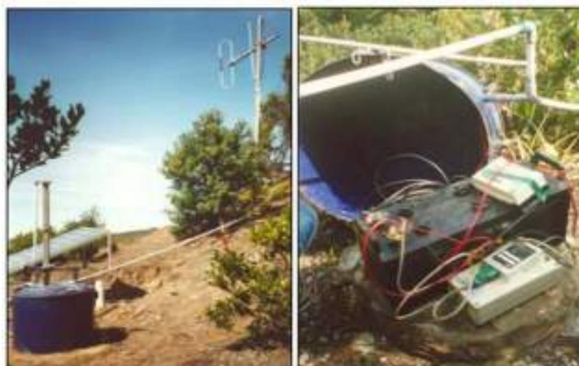
Gambar 1. 12 : prototipe stasiun GPS frekuensi tunggal (Slave) di Gunung Papandayan
