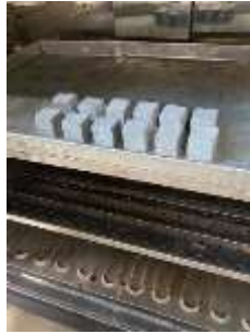
Gambar 3. 88 Pengeringan benda uji penyerapan air mortar dalam oven
