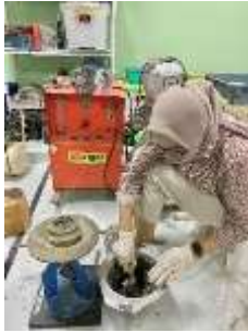
Gambar 3. 80 Pengisian kerucut dalam 2 lapis
