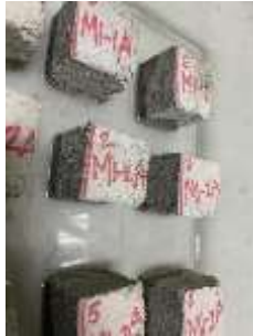
Gambar 3. 92 Menambahkan air sampai benda uji terendam ( 3 \pm 0,5 ) mm
