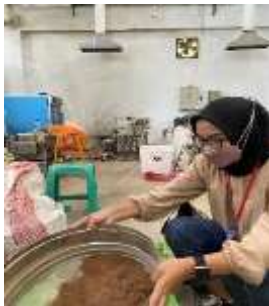
Gambar 3. 21 Mengayak hydrochar lolos 40 mesh dan tertahan 100 mesh
