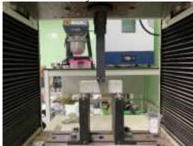
Gambar 3. 106 Pengujian Kuat Lentur Mortar
