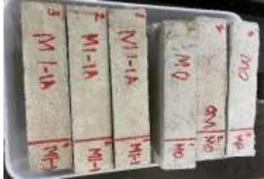
Gambar 3. 103 Pengeringan benda uji lentur dari tempat perendaman
