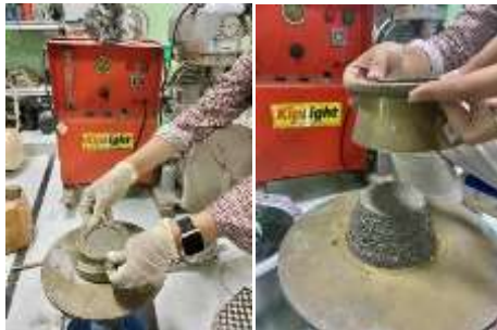
Gambar 3. 84 Kerucut diangkat dan adukan membentuk kerucut
