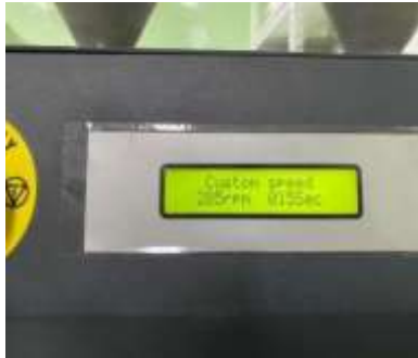
Gambar 3. 69 Kecepatan mixer menjadi 285 rpm selama 15 detik
