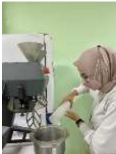
Gambar 3. 63 Semen dan air dimasukkan dalam mixer
