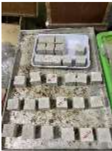
Gambar 3. 97 Pengeringan benda uji tekan dari tempat perendaman
