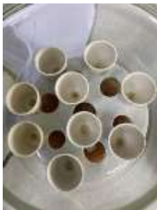
Gambar 3. 45 Abu setelah proses pengujian kadar abu
