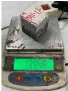
Gambar 3. 93 Pengukuran berat akhir benda uji
