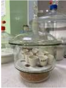
Gambar 3. 40 Krusibel dalam desikator untuk didinginkan
