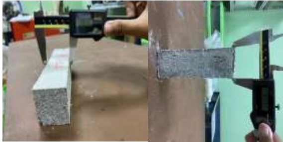
Gambar 3. 105 Pengukuran lebar dan tebal benda uji lentur
