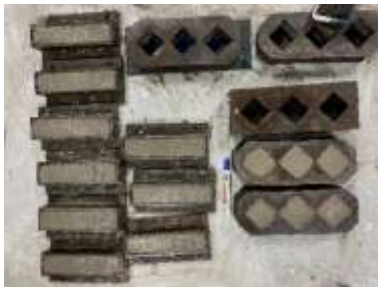
Gambar 3. 75 Mortar yang sudah dicetak dan akan ditunggu sampai mengeras
