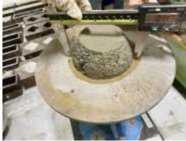
Gambar 3. 87 Pengukuran diameter adukan setelah penggetaran
