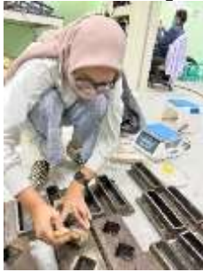
Gambar 3. 70 Pemberian minyak pelumas pada cetakan benda uji
