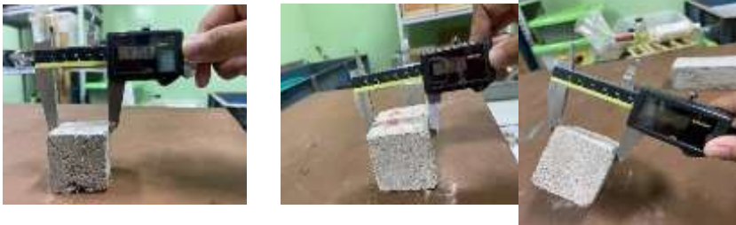
Gambar 3. 89 Pengukuran dimensi panjang, lebar dan tinggi sebanyak masing-masing 3 kali
