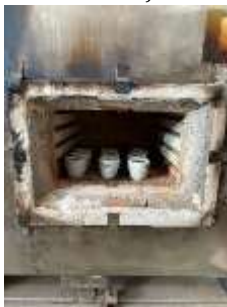
Gambar 3. 43 Arang dimasukkan ke dalam tanur dengan suhu 700^{\circ}\text{C}
