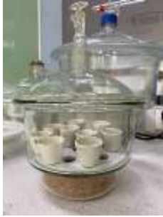
Gambar 3. 44 Abu didinginkan pada desikator
