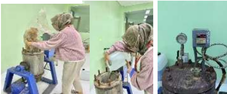
Gambar 3. 17 Proses Karbonisasi Hydrothermal selama 1, 2 dan 3 jam pada suhu 160^{\circ}\text{C}
