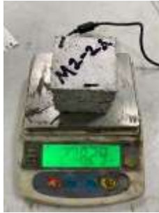
Gambar 3. 98 Penimbangan berat benda uji kuat tekan mortar
