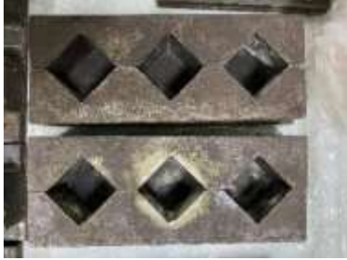
Gambar 3. 50 Cetakan Benda Uji Kubus 50 mm x 50 mm x 50 mm
