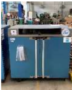
Gambar 3. 9 Oven Memmert UF 450, 400 V, 8.4 A, 5800 watt
