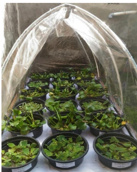
Gambar 1. Proses Fitoremediasi pada Green House (Sumber: Penelitian, 2016)
