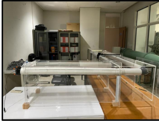
Gambar 4. Model Fisik Terowongan Skala Laboratorium Tampak Samping
