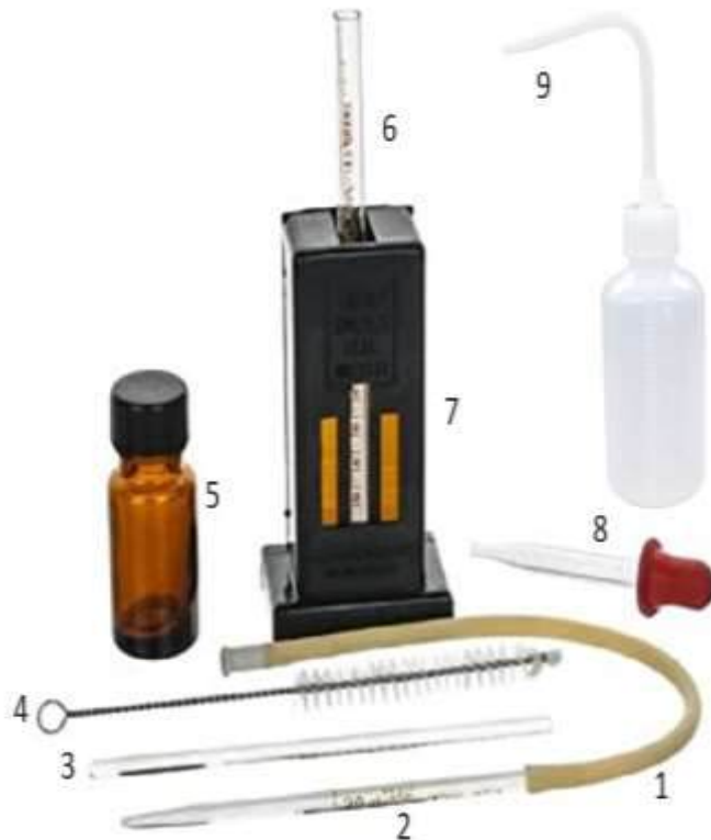
Gambar 4. Alat dan bahan Pemeriksaan Hb metode Sahli 1. Pipet hisap; 2. Pipet Sahli; 3. Batang Pengaduk; 4. Pembersih Tabung; 5. HCl 0,1N; 6. Tabung hemometer; 7. Rak standar; 8. Pipet Pasteur; 9. Aquadest
